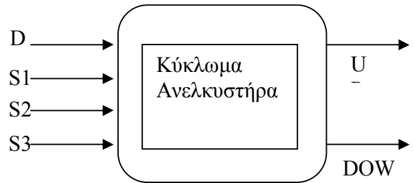
Εικόνα 29. Είσοδοι / έξοδοι κυκλώματος λήψης απόφασης λειτουργίας ανελκυστήρα.
