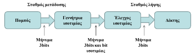
Εικόνα 69. Απλό ψηφιακό σύστημα μετάδοσης μηνυμάτων.
