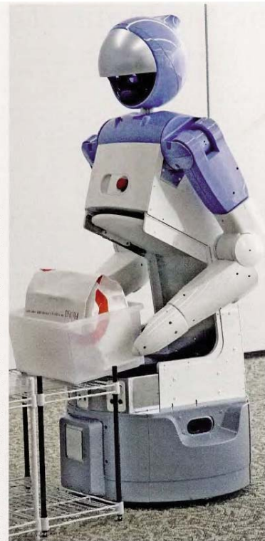
Οι μηχανικοί βραχίονες του ρομπότ μεταφέρουν το κιβώτιο και το τοποθετούν στο τραπέζι. Η χρήση των ρομπότ σε αποθήκες και δίκτυα διανομής προϊόντων διαρκώς επεκτείνεται.
