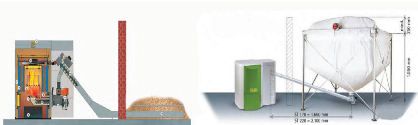
Σχήμα 4: Αυτόματη τροφοδοσία λέβητα κεντρικής θέρμανσης με wood pellets .
