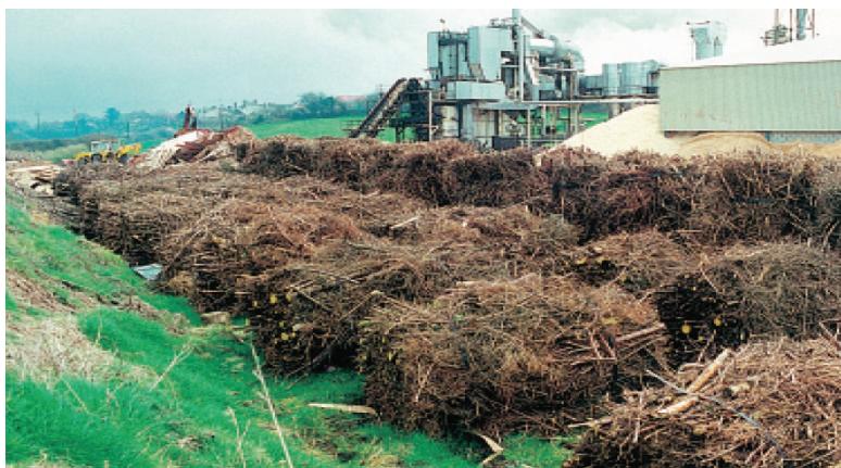
Εικόνα 5: Δεματοποιημένα υπολείμματα σε εργοστάσιο συμπαραγωγής θερμότητας [32].
