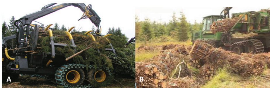
Εικόνα 4: Α. Συλλογή υπολειμμάτων από γερανό, δεματοποίηση και φόρτωση σε μετατοπιστή. Β. Φόρτωση και εκφόρτωση δεσμών υπολειμμάτων με τη χρήση βραχίονα με αρπάγη. http://www.amandlaresources.com/renewable-energy.php http://article.wn.com/view/2014/07/31/China_adopts_stricter_pesticide_residue_standard
