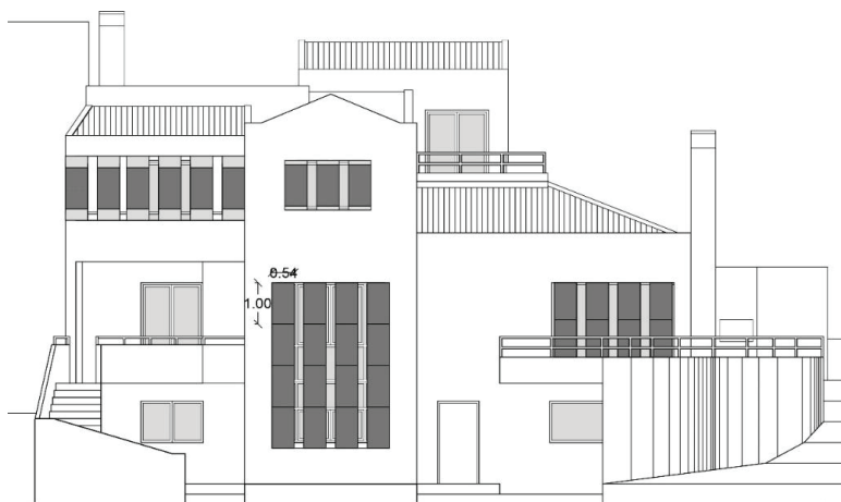
Εικόνα 7: Αποψη της εγκατάστασης των ΦΒ περσίδων στη νοτιοδυτική όψη
