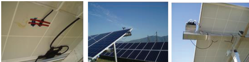
Εικόνες 3,4,5 : Ο μετεωρολογικός σταθμός Sunny Sensorbox και οι αισθητήρες του.
