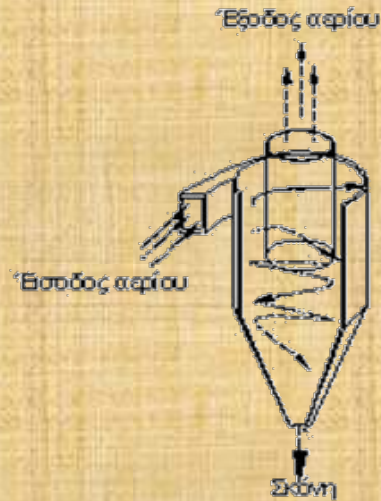
Εικόνα 1: Σχηματική απεικόνιση της κίνησης αερίου ρεύματος στο εσωτερικό κυκλώνα
