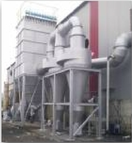
Αποκονίωση χυτηρίου σκραπ αλουμινίου
