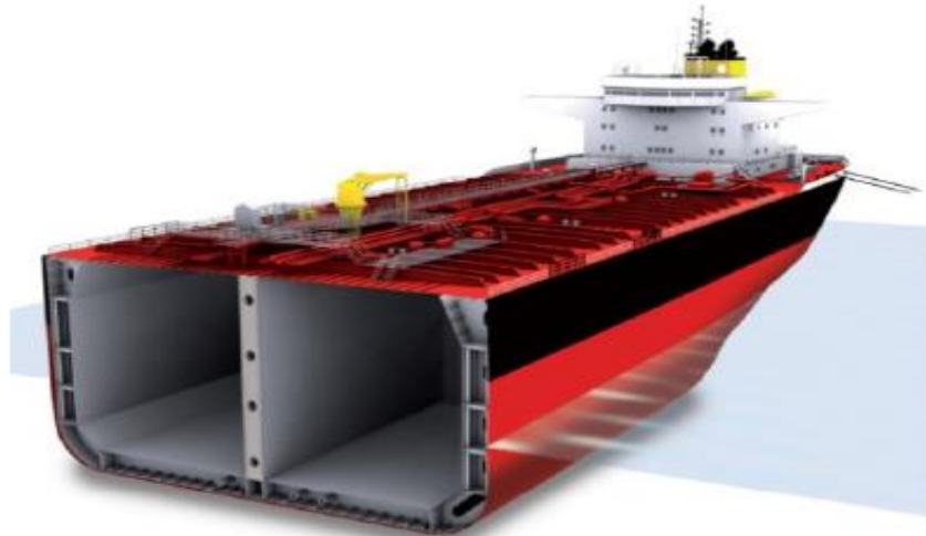
Εικόνα 12: Τομή Δεξαμενοπλοίου Διπλής Γάστρας (Double Hull Tanker - DHT).
