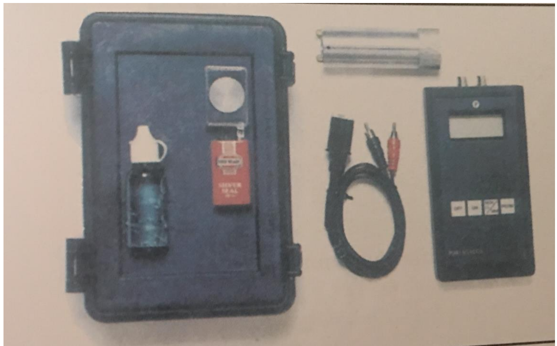
Εικόνα 5: Εξοπλισμός παχυμέτρησης με υπερήχους (όργανο ψηφιακής ένδειξης)
