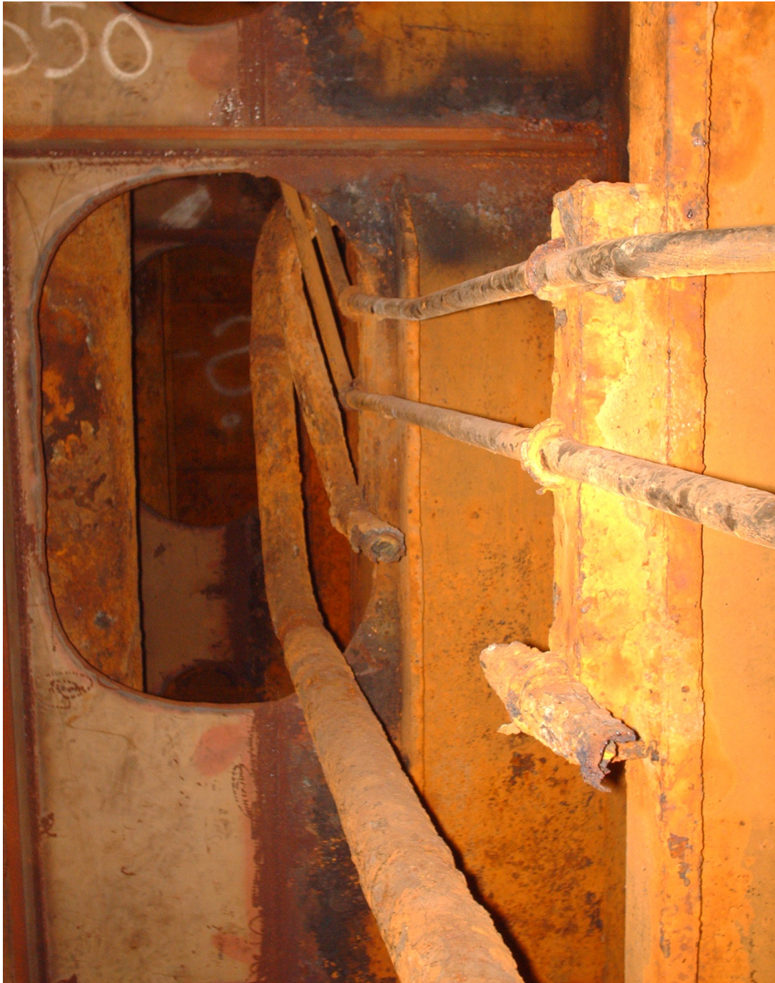
Εικόνα 1: Επίδραση της διάβρωσης σε άνω πλευρική δεξαμενή.
