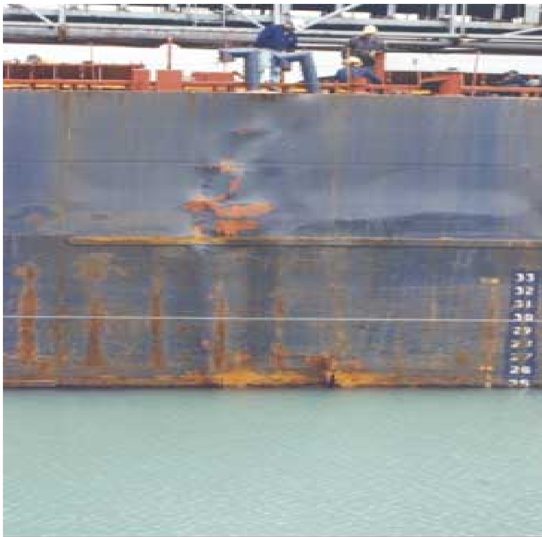
Εικόνα 6: Λυγισμός πλευρικών ελασμάτων δεξαμενόπλοιου.
