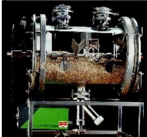
Ζυμωτήρας Paddle Mixer (Αναμίκτης πτερυγίων)
