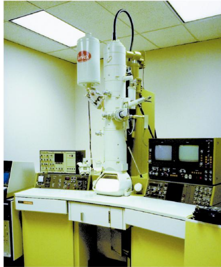
Εικόνα 4.9 Ηλεκτρονικό μικροσκόπιο. Το συγκεκριμένο όργανο λειτουργεί τόσο ως ηλεκτρονικό μικροσκόπιο διέλευσης όσο και ως ηλεκτρονικό μικροσκόπιο σάρωσης.
