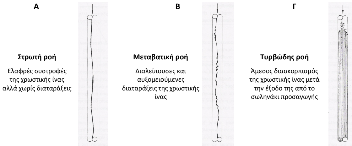
Εικόνα 2 Οι τρεις κλάσεις στις οποίες κατατάχθηκαν οι φωτογραφίες της ροής για διάφορες τιμές παροχής και θερμοκρασίας.
