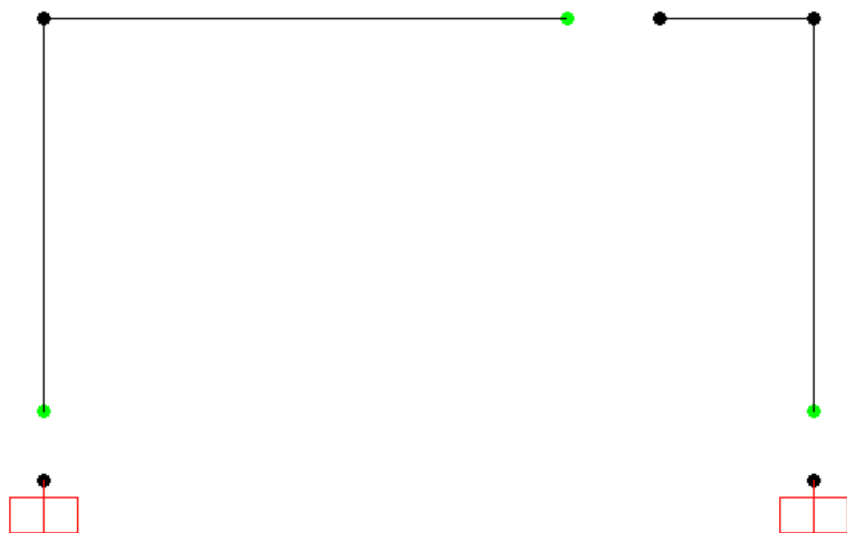
Σχήμα 4.4 Εικόνα του φορέα μετά την εισαγωγή αρθρώσεων στη δοκό και στη βάση των υποστυλωμάτων.
