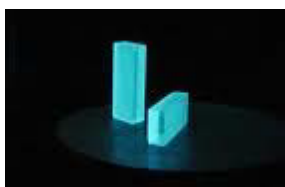
Σχήμα 17: « Διάφοροι τύποι ανιχνευτών: BaF 2 , BGO, plastic scintillators αντίστοιχα»
