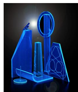
Σχήμα 17: « Διάφοροι τύποι ανιχνευτών: BaF 2 , BGO, plastic scintillators αντίστοιχα»
