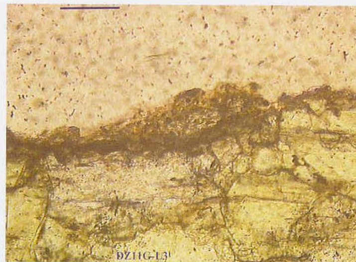
Φωτ. 86. Δοκίμιο Δ.Ζ.ΧΙ.γ. Λεπτομέρεια της περιοχής \Lambda_3 μετά τον καθαρισμό με λείζερ. (Πολωτικό μικροσκόπιο). (Φωτ. Ε. Δήμου)
