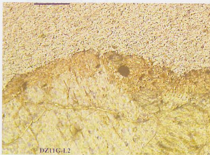
Φωτ. 85. Δοκίμιο Δ.Ζ.ΧΙ.γ. Λεπτομέρεια της περιοχής \Lambda_2 μετά τον καθαρισμό με λείζερ. (Πολωτικό μικροσκόπιο). (Φωτ. Ε. Δήμου)
