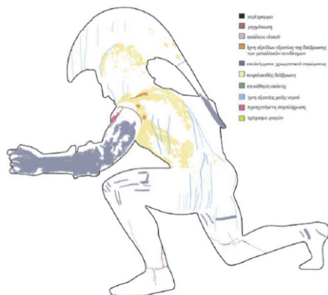
Εικόνα 2: Ψηφιακή αποτύπωση των φθορών στο αντίγραφο 9.
