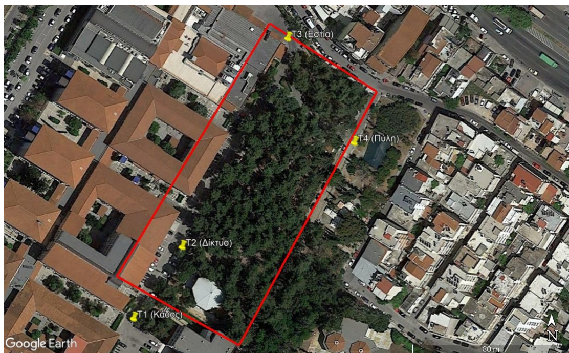
Σχήμα 2: Όρια περιοχής αποτύπωσης και θέση των σταθερών σημείων
