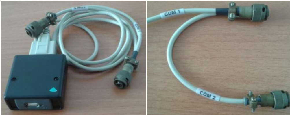
Εικόνα 37: Καλώδιο μεταφοράς δεδομένων από το βαρυτήμετρο στον ηλεκτρονικό υπολογιστή.
