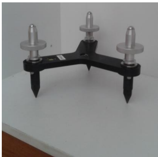
Εικόνα 35: Ειδική βάση οριζοντίωσης του βαρυτημέτρου.
