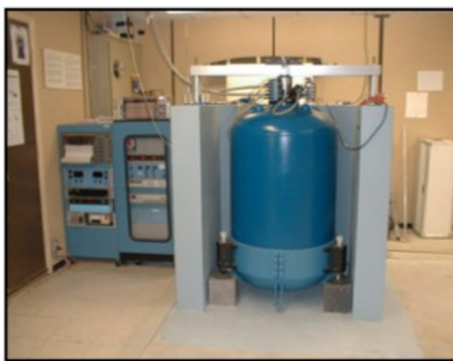
Εικόνα 17: Τυπική πλήρης διάταξη ενός υπεραγωγικού βαρυτημέτρου μαζί με τις απαραίτητες ηλεκτρονικές μονάδες.
