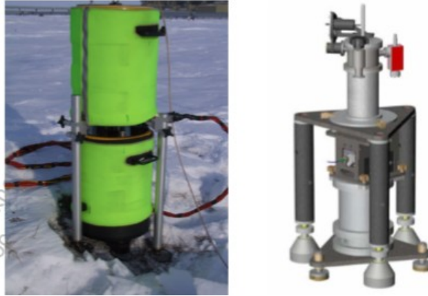
Εικόνα 16: Φορητά απόλυτα βαρυτήμετρα νέας γενιάς: μοντέλο A-10(αριστερά) & I-10(δεξιά) της Microsolutions-g, Colorado
