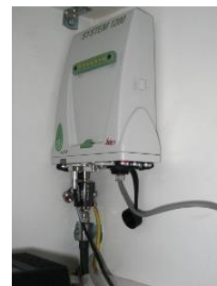
Σχήμα 4.6β: Σύστημα μόνιμου σταθμού
