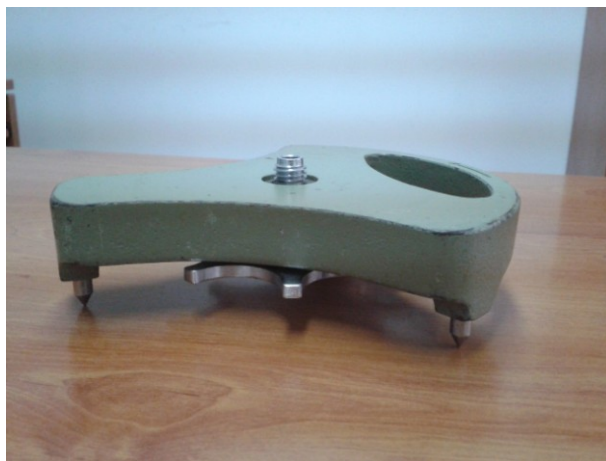
Εικόνα 3.2 Μηχανισμός κέντρωσης δέκτη GPS σε βάθρο
