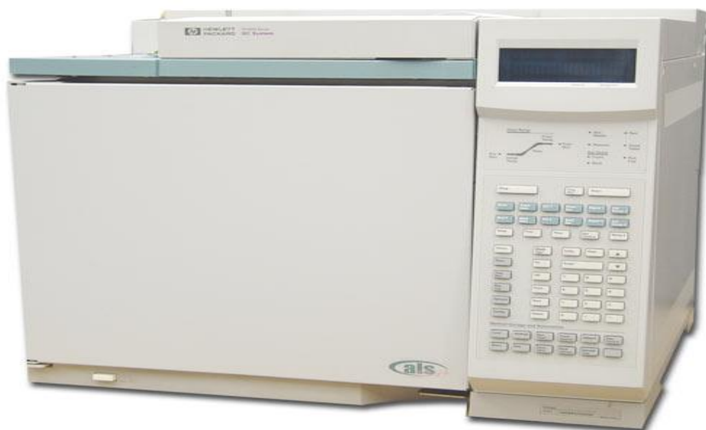
Σχήμα 7: Αεριοχρωματογράφος Agilent 6890 Series Gas Chromatograph
