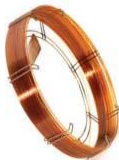
Σχήμα 8: Στήλη:DB-23 capillary column (60m×0.25mm i.d., 0.15 μm film) [50%-Cyanopropyl) methylpolysiloxane], υψηλήςπολικότητας, σχεδιασμένη για την ανάλυση μεθυλεστέρωνλιπαρόνοξέων(FAMEs), με εξαιρετική διαχωριστική ικανότητα των cis- και trans- FAME ισομερών
