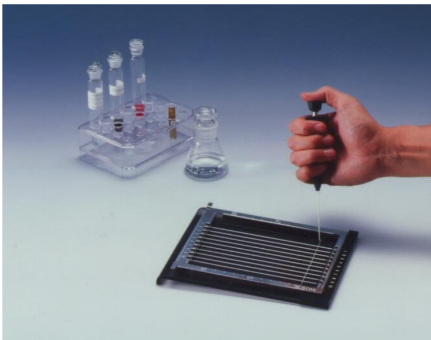
Σχήμα 2: Τοποθέτηση δείγματος στα Chromarods
