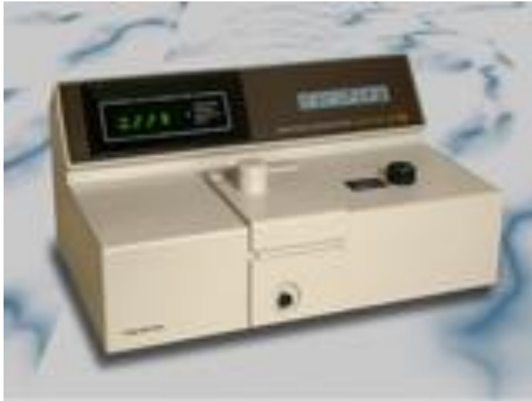
Σχήμα 4. Φασματοφωτόμετρο Vis απλής δέσμης
